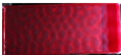
شکل ۵: (شکل چپ) طرح مشاهده شده در بسامد ۴۰ هرتز در ظرفی مستطیلی با عمق ۱/۵ سانتی‌متر در حضور لایه کشسان. (شکل راست) طرح شبیه‌سازی شده متناظر با آن در نرم‌افزار MATLAB.
