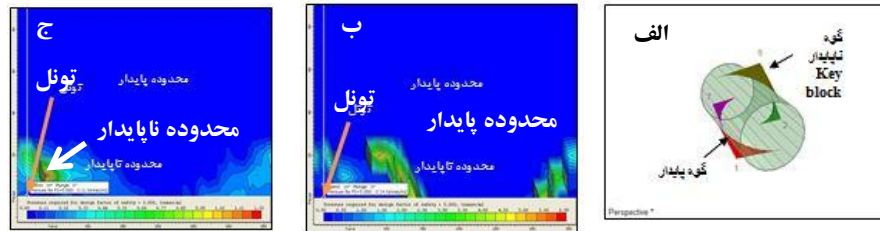
شکل (11): الف: تشکیل بلوک کلیدی (Key Block) در سقف تونل، ب: قرارگیری تونل در محدوده پایدار در شرایط عادی، ج: قرارگیری تونل در محدوده ناپایدار در شرایط وقوع زمین لرزه (نرم افزار Unwedge3.0)
