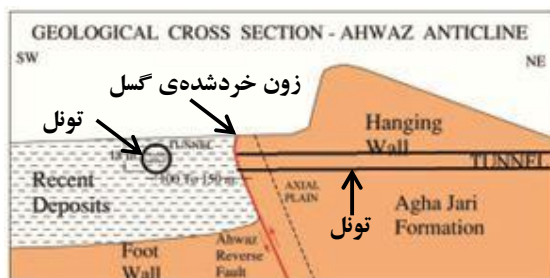
شکل (8): موقعیت زون خردشده‌ی گسل اهواز نسبت به بخش مرکزی تونل خط 1 مترو
