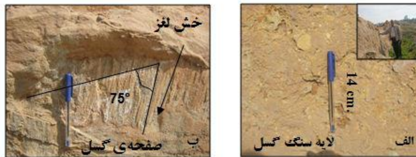
شکل (4): سنگ گسل از نوع کاتاکلاستیک و خش لغز در زون گسل اهواز - منطقه صنایع فولاد الف: سنگ کاتاکلاستیک سنگ گسل. ب: خش لغز سطح گسل
