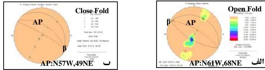
شکل (3): تصویر استریوگرافیک نمودار \pi تاقدیس اهواز. الف: محدوده کل تاقدیس ب: در محدوده منطقه صنایع فولاد (برگشتگی در بال جنوب غربی)
