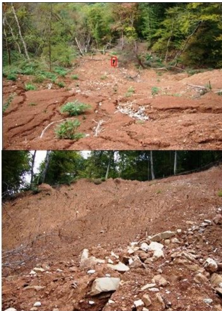
شکل ۴ - نمایی از حرکت توده ای خاک کنار جاده و نشانه های آن
