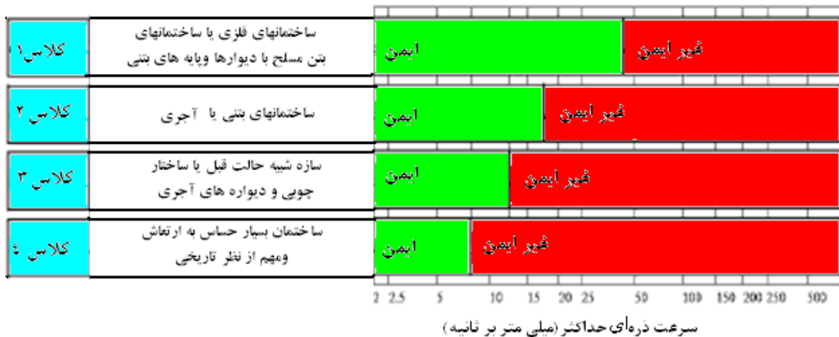
شکل ۳ - حد تخریب ساختمانها بر اساس سرعت ذره‌ای حداکثر (ویس، ۱۹۸۱).
