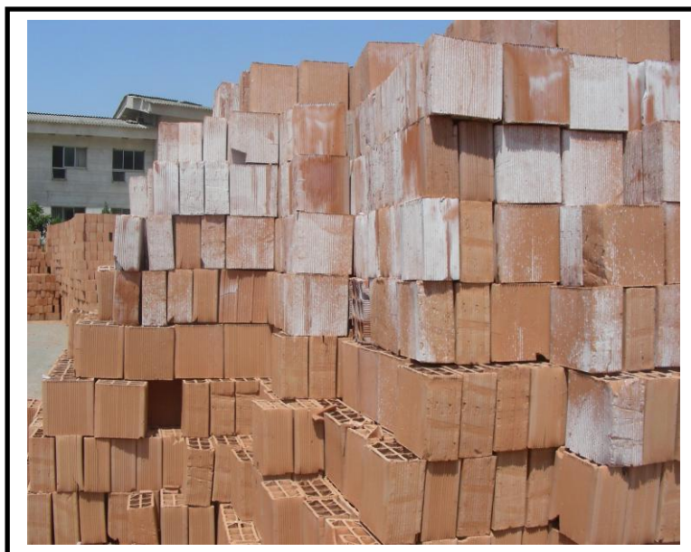
شکل ۲ آلوئک و سفیدک‌های مشاهده شده در محصولات کارخانه آجرسازی نصرآباد
