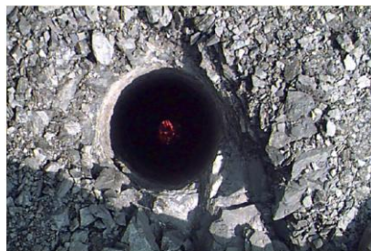
شکل ۷- نمونه‌ای از گمانه پایش و اندازه‌گیری گرمایش خودبخودی لایه زغال (Huw et al., 2002)
