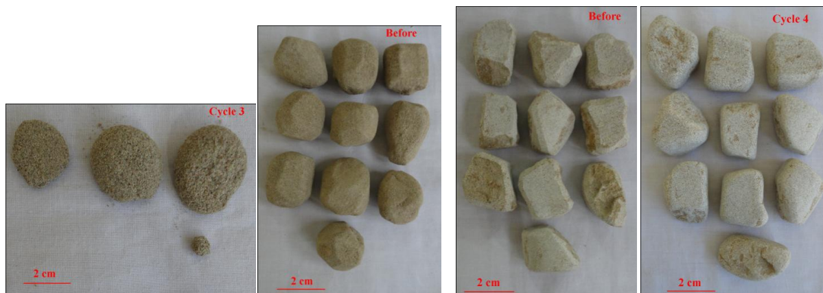
شکل ۵ - نمونه‌هایی از کلوخه‌های سنگی قبل و بعد از آزمایش دوام وارفتگی با زمان‌های مختلف. الف) ماسه سنگ PZ-1 و ب) - نمونه SG.
