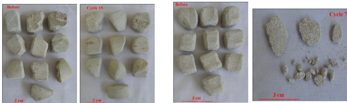
شکل ۳- نمونه هایی از کلوخه های سنگی قبل و بعد از آزمایش دوام وارفتگی. الف) ماسه سنگ PZ-1 و ب) نمونه RG.
