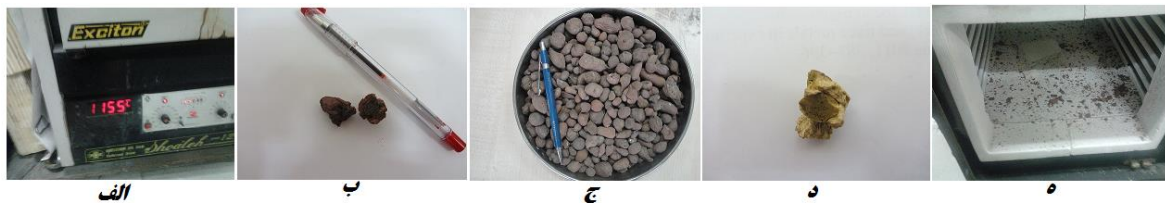
شکل ۴- الف) دمای مناسب برای شیل بکت ب) نمونه منبسط شده شیل نورآباد ج) نمونه منبسط شده شیل بکت د) نمونه منبسط شده مارن رازک ه) حالت انفجاری شیل نورآباد
