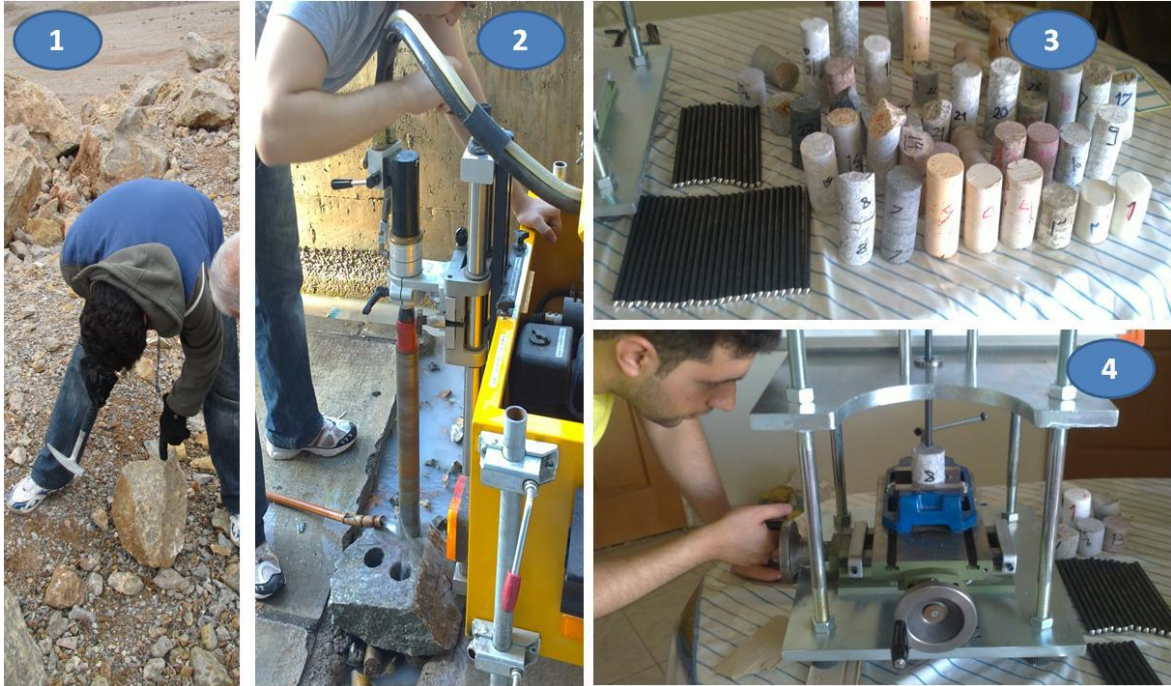
شکل ۱- مراحل انجام آزمون سرشار: (۱-نمونه برداری در بازدید میدانی، ۲-مغزه گیری از بلوک های سنگی، ۳- آماده سازی نمونه ها و سوزن ها و ۴-انجام آزمون سرشار)
