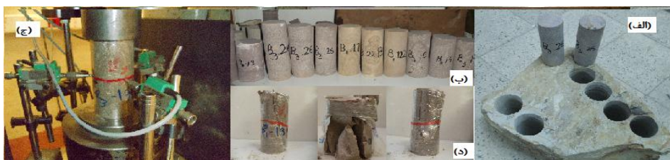
شکل ۲- مراحل انجام آزمایش تک محوری: الف- تهیه مغزه از بلوک‌های ماسه سنگی، ب- سایش دو سر مغزه ها، ج- انجام آزمایش تک محوری، د- نمونه‌های شکسته شده بعد از بارگذاری
