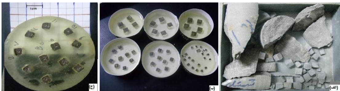
شکل ۳- مراحل آماده‌سازی نمونه آزمایش نفوذ، الف- خرد کردن و تهیه نمونه‌ها در اندازه مشخص، ب- قرارگیری نمونه‌ها در قالب رزین، ج- نمونه آماده انجام آزمایش
