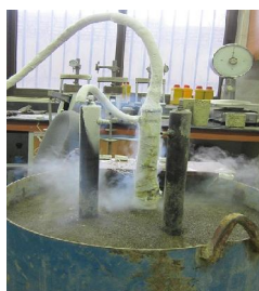
شکل ۷- شروع تزریق نیتروژن به درون لوله انجماد در خاک ماسه‌ای
