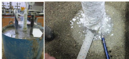
شکل ۱۰- تشکیل شعاع انجماد در اطراف لوله‌ی انجماد نصب شده در خاک ماسه ای
